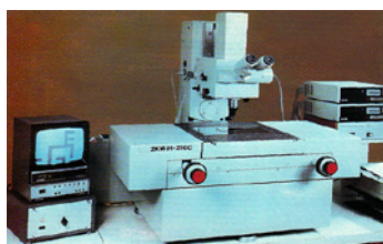
Рис. 10: Двухкоординатный измерительный прибор «ZKM-01-250-C», измерительная головка с переходником для телекамеры и фотоэлектрическим измерительным устройством «FEM» (1985 г.).
