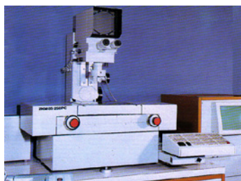
Рис. 7: Двухкоординатный измерительный прибор «ZKM -05-250-PC» с ЭВМ «Электроника-60» (1982 г.).
